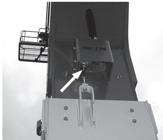
2-8 pav. Kolonos strėlės horizontalios padėties galinis jungiklis.
